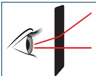
**4 Dependencia angular del factor de transmisión en el espectro visible:**
