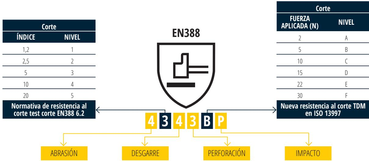
Para los guantes hechos de materiales muy resistentes (materiales que desafilan la cuchilla durante el test), el Test de Corte ya no es relevante, un test TDM es obligatorio. El test TDM es igualmente más representativo de situaciones de trabajo con riesgo de corte elevado.
