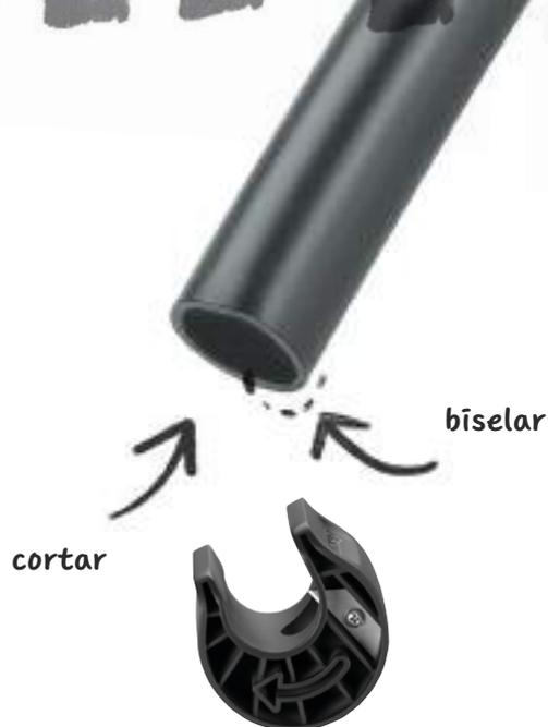
**B** Corte los tubos a la longitud correcta según el plan. Asegúrese de que no entre tierra en la tubería. Si es necesario, limpie la tubería, es decir, elimine los bordes cortados sucios. Para cortar tubos rectos rápidamente, utilice el cortatubos GARDENA para cortar los tubos de conexión (art. n.º 2727).
