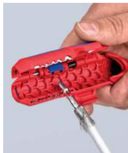
Pelar un cable coaxial
