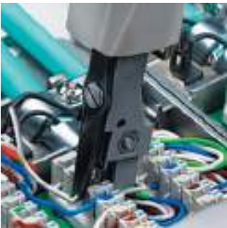
Corta y presiona en una sola operación
