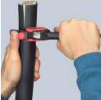
Girar la herramienta para el corte perimetral
