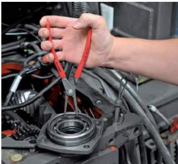
Puntas estables insertadas, fabricadas en acero para muelles de alta densidad
