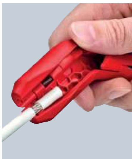
Retirar el aislamiento de un cable coaxial
