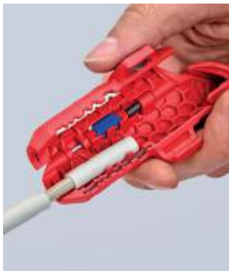
Pelar un cable NYM
