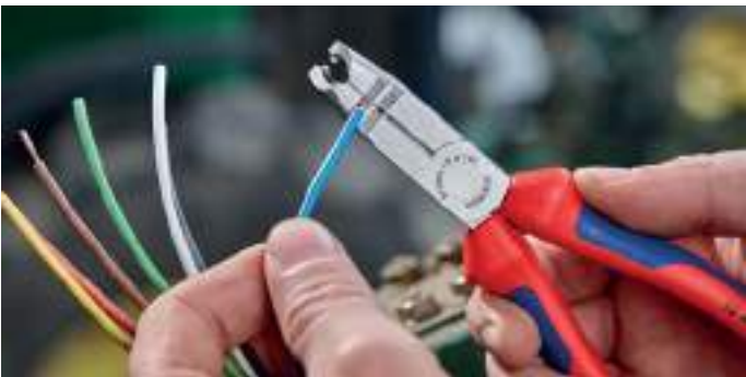
Orificios para retirar el aislamiento en conductores de 1,5 y 2,5 mm²
