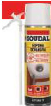
Espuma de poliuretano multi-posición con excelentes propiedades térmicas y acústicas que protege contra el calor, el frío, la humedad y el ruido. Especialmente adecuada para el aislamiento y el relleno de agujeros y cavidades, por dentro y por fuera. Al ser una multi-posición tiene una rotación de 360°, en otras palabras, el bote puede usarse en todas las posiciones. Ideal para la aplicación de espuma aislante en lugares de difícil acceso. Potencia de aislamiento: +/- 0.04 W/m.K
