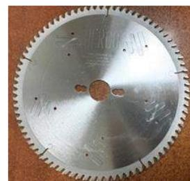
Sierras construidas con cuerpo de acero y placas HM, este grupo de sierras son de corte trapezoidal plano (TP). Se fabrican en diferentes diámetros y cortes según la máquina y el material a cortar ( tableros aglomerados rechapados con melamina por las dos caras u otros estratificados )
