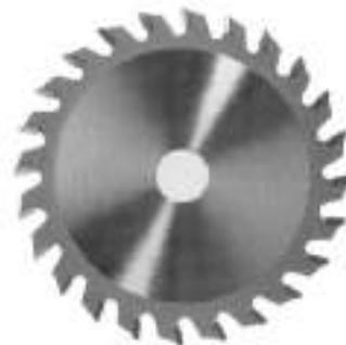
Construida con cuerpo de acero y placas HM soldadas se fabrican con los dientes cónicos en varios diámetros y cortes, el trabajo que realiza este incisor es abrir camino para cuando empiece a cortar la sierra evite cualquier tipo de astilla
